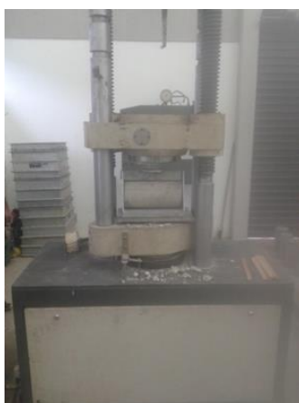
Figura 2 - Corpo de prova submetido ao ensaio de tração por compressão diametral (AUTOR (2016))
