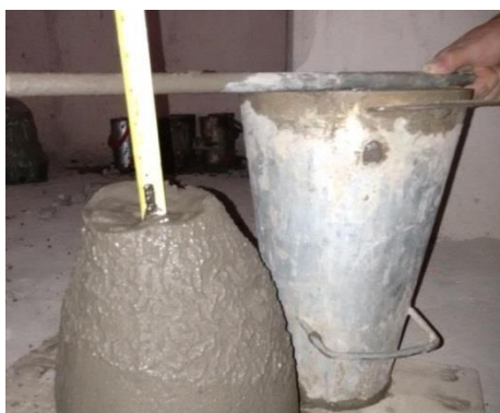
Figura 7 – Ensaio de abatimento do tronco de cone.
