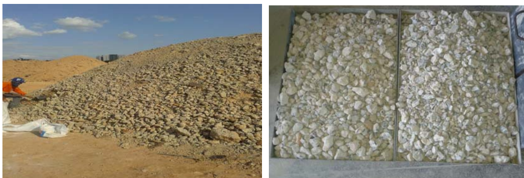
Figura 1. Recolhimento de material no Shopping Rio Poty e aspecto visual dos resíduos de concreto utilizados no concreto reciclado.
