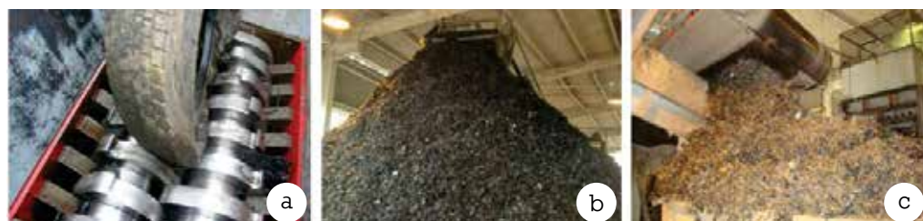
Figura 3 – Etapas de reciclagem para obtenção das fibras de aço de pneus
